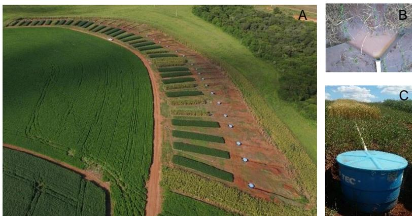
**Figura 1.** Vista aérea das parcelas experimentais (A) e detalhes do sistema de condução (B) e coleta do escoamento superficial (C). Júlio de Castilhos-RS.
